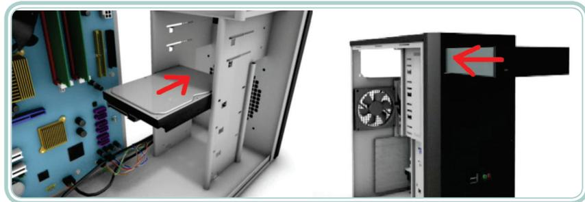
**Figura 8.15: Instalando HD e drive óptico**
