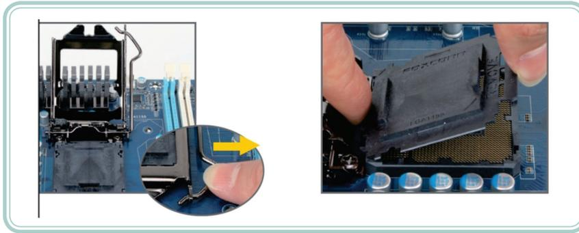
**Figura 8.5: Removendo a tampa da CPU**
