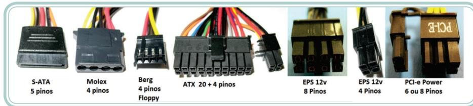
**Figura 8.17: Conectores da fonte de alimentação**
