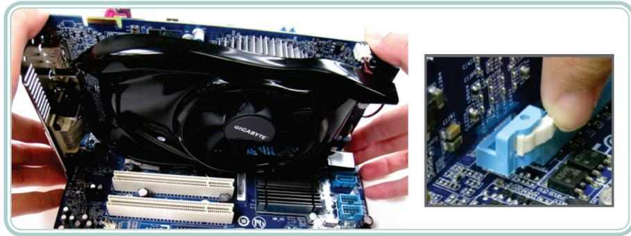
**Figura 8.19:** Instalando uma placa de vídeo PCI Express
